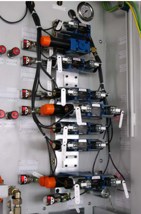
Abb. 20 Kennzeichnung von Hydraulikventilblöcken
