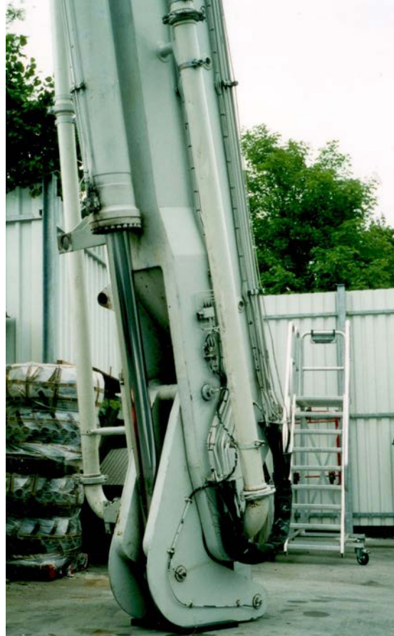
Abb. 38 Auf den Boden abgesenkter Ausleger einer Betonpumpe
