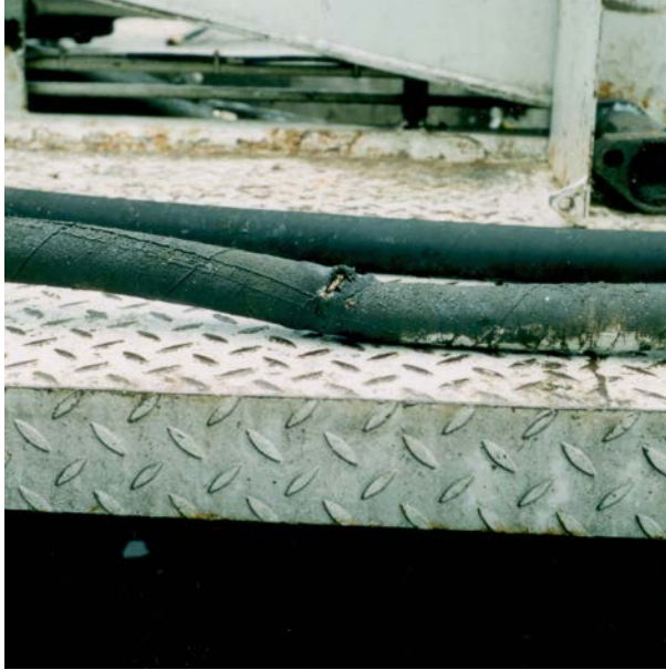
Abb. 2 Geborstene Hydraulik- Schlauchleitung
