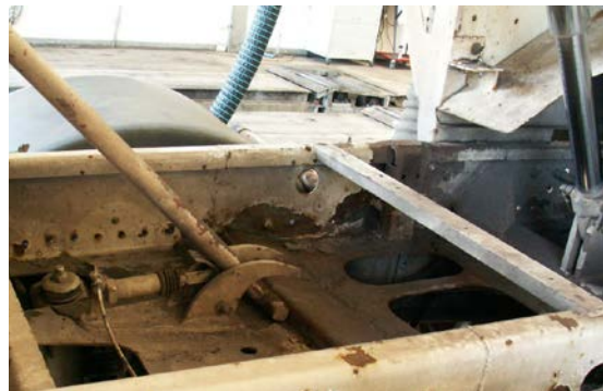
Abb. 37 Sicherungsstütze an einem hydraulisch angehobenen Fahrzeugaufbau
