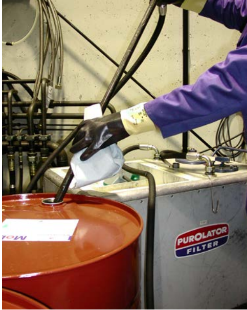
Abb. 5 Persönliche Schutzausrüstung beim Ölwechsel
