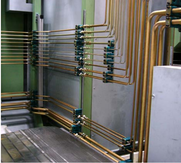
Abb. 10 Fachgerechte Befestigung von Rohrleitungen mit Leitungshalterungen
