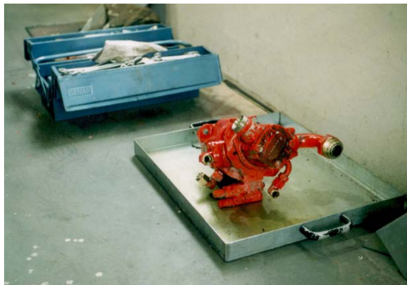
Abb. 19 Mobilhydraulik- pumpe in einer Ölauffangwanne
