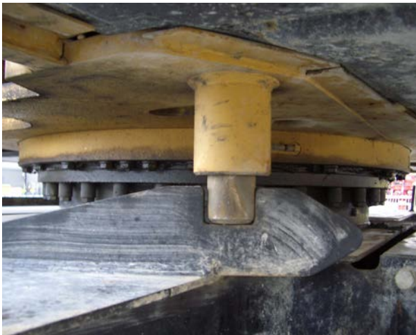
Abb. 40 Dreh Sperre an einem Hydraulikbagger in Sperrstellung
