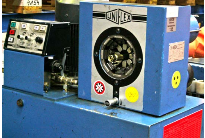
Abb. 14 Vorrichtung zum Verpressen von Schlaucharmaturen
