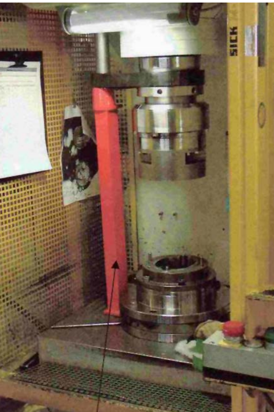
Abb. 28 Eingesetzte Abstützung an einer hydraulischen Presse
