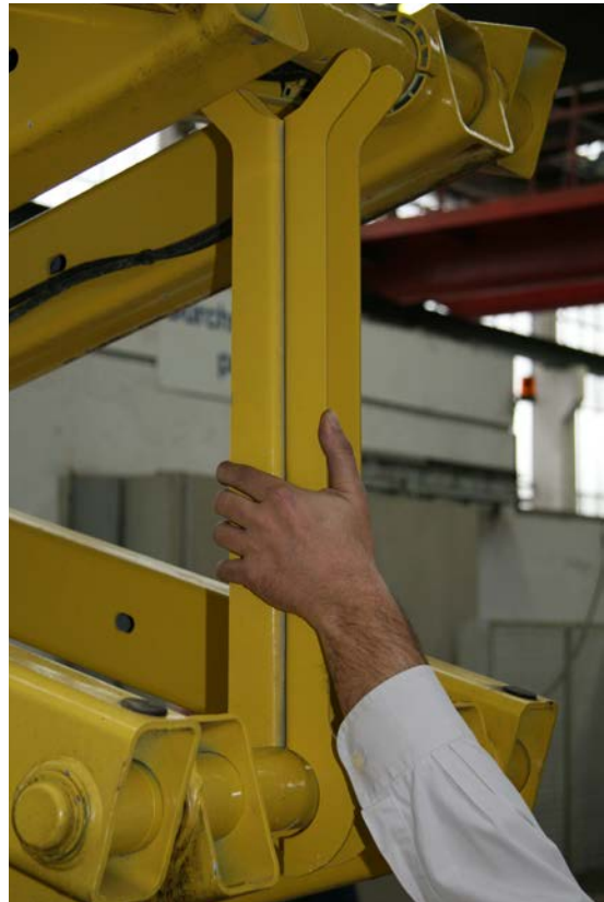
Abb. 29 Eingelegte Wartungsstütze an hydraulischer Scheren-Hubarbeitsbühne
