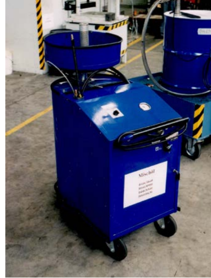
Abb. 34 Hilfsgerät zur Entsorgung von alter Druckflüssigkeit
